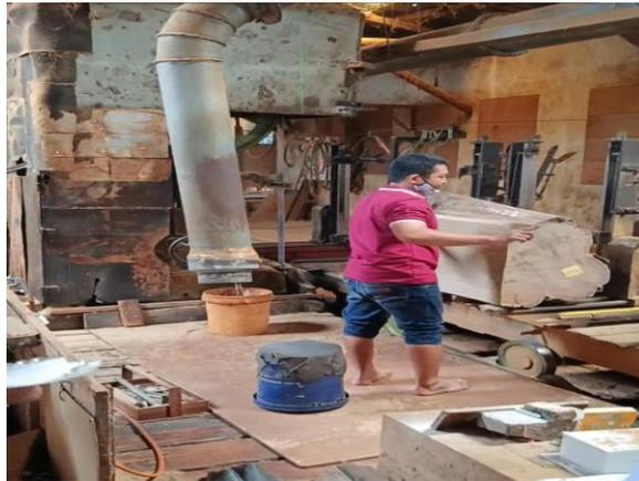
**Gambar 1 : Pengoperasian Mesin Bandsaw**
